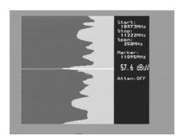
Drehen Sie das LNB so, dass entweder die Horizontal- oder Vertikal-Polarisation in seinem Maxim steht – justieren Sie die Kreuzpolarisation.
