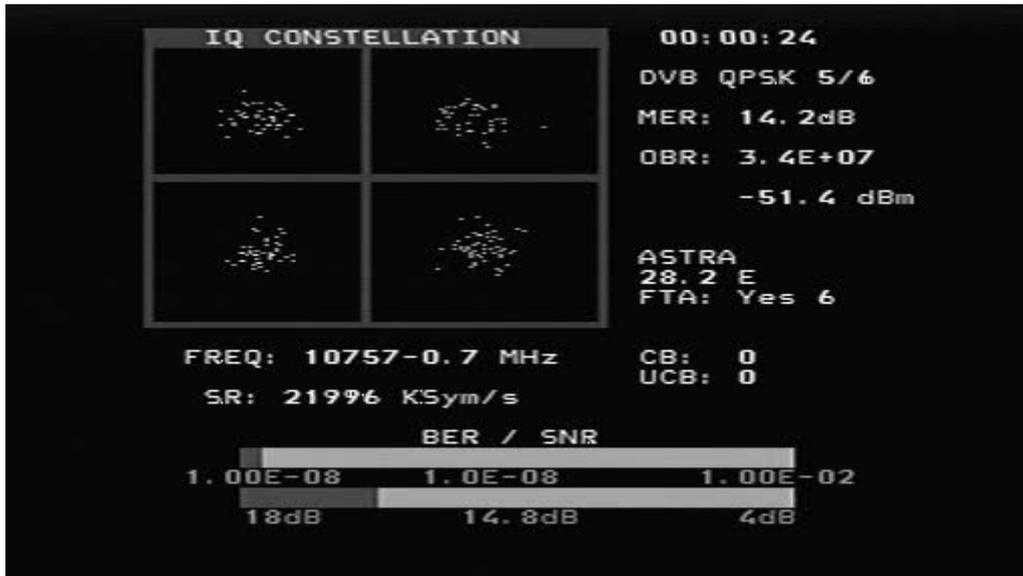
Cela montre une constellation typique de signal DVB-S QPSK. La fréquence et le décalage sont indiqués ci-dessous sur le diagramme de constellation et le taux de symbole mesuré est au-dessous de la fréquence. Les deux barres du thermomètre indiquent le BER et SNR du signal. Le thermomètre SNR augmente de droite à gauche et le thermomètre BER devient plus petit de droite à gauche, de sorte que le meilleur signal est représenté par une barre plus blanche.
