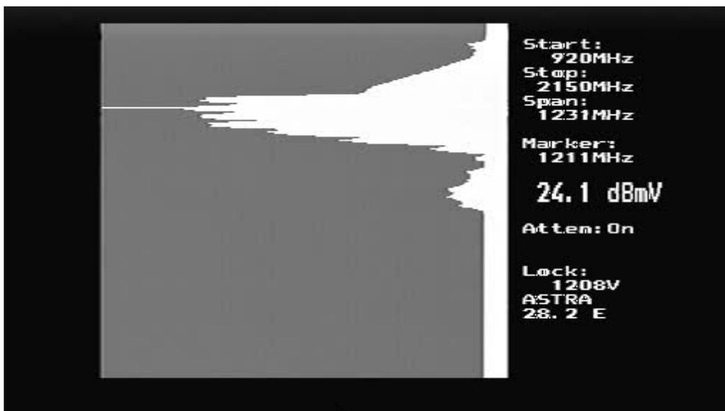
Rappelez vous que la bande Unicâble affichée se reflète dans la fréquence sur la fréquence d'utilisation de bande comme le montre l'exemple ci-dessous. Pour plus de détail, veuillez voir l'annexe D.
