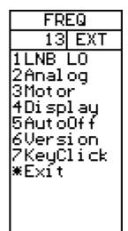
**Motor)** O tipo de posicionador pode ser configurado aqui. O tipo de posicionador mais comum é o DiSEqC(Dis 1.2) e os outros tipos suportados são Satsel e Satscan.
