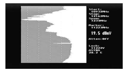
Dado que a banda UniCable tem apenas 100MHz de largura, é mais útil examinar esta banda com o span configurado para 250MHz. Para mais detalhes ler Apêndice D.
