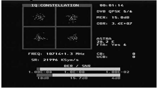
Isto mostra uma constelação típica do sinal DVB-S QPSK. A frequência e offset são mostrados por baixo do diagrama de constelação e o symbol rate medido é mostrado abaixo da frequência. As duas barras tipo termómetro mostram o BER e o SNR do sinal. A barra SNR aumenta da direita para a esquerda e a barra de BER fica menor da direita para a esquerda, para que o melhor sinal seja mostrado por uma barra longa branca.
