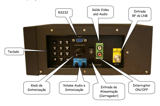
**Interruptor ON/OFF)** Quando alimentado pela bateria, este liga e desliga o instrumento. Quando o carregador está ligado, o instrumento irá carregar quando o interruptor está OFF e operar quando o operador está ON. O instrumento não irá carregar quando está a operar.
