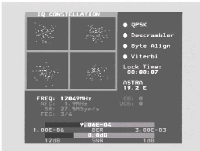
**Remarque :** Le taux d'erreur (BER) doit être le plus faible possible. Il est présenté sous la forme d'un nombre avec une puissance négative, par exemple «  $5 \cdot 10^{-4}$  ».
