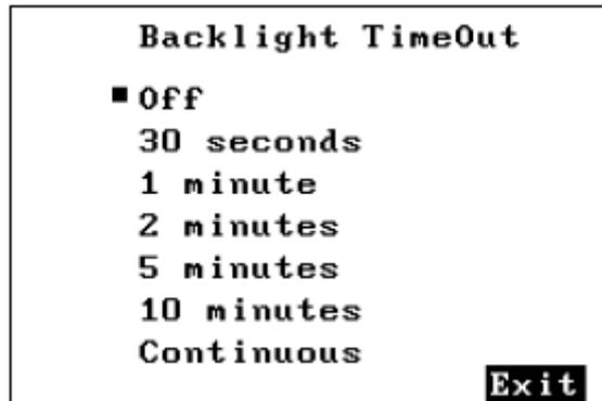
Sie könnten das Gerät so einstellen, dass sich das Hintergrundlicht nach einer bestimmten Zeit automatisch abschaltet. Dies wird dann als Standardeinstellung beim Hochfahren gespeichert.
